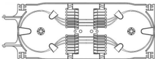
Encaixe a tampa plástica após realizar o procedimento anterior para todas as fusões necessárias. Acomode as sobras do tubo loose no suporte atrás das bandejas e una com a fita velcro as bandejas e o suporte com os tubos loose.
