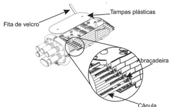
As canaletas das bandejas podem alojar até duas emendas cada uma. Realize as fusões das fibras e armazene-as nas canaletas das bandejas. Acomode as fibras nos arcos superior e inferior da bandeja.
