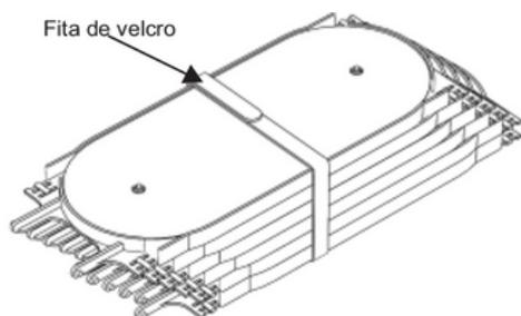
Retire o velcro da amarração e as tampas plásticas das bandejas. Fixe os tubos loose necessários nas bandejas com as abraçadeiras plásticas fornecidas, usando 2 abraçadeiras em cada lado da bandeja, conforme imagem ao lado.
