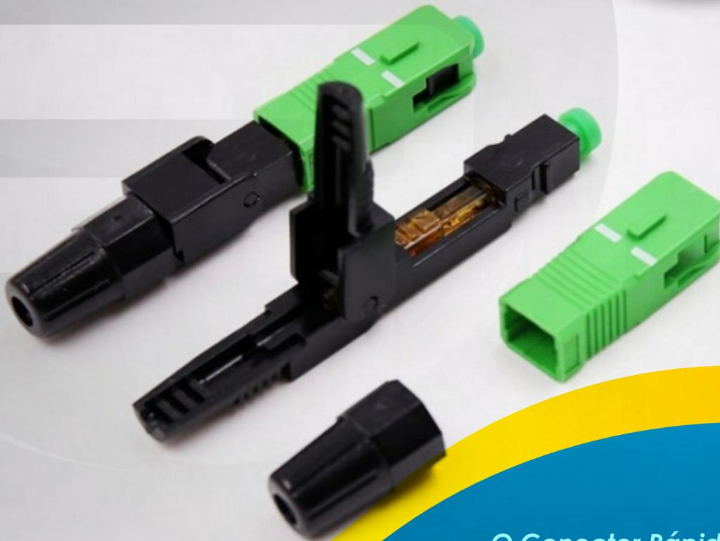
O Conector Rápido Jacaré APC foi desenvolvido para ser utilizado em campo em cabos Drop Flat (Low Friction) de até 3 mm. Fácil montagem, não exige nenhuma ferramenta especial, além de ferramentas normais para preparação da fibra óptica (decapador do cabo, decapador da fibra, gabarito, clivador e componentes de limpeza).
